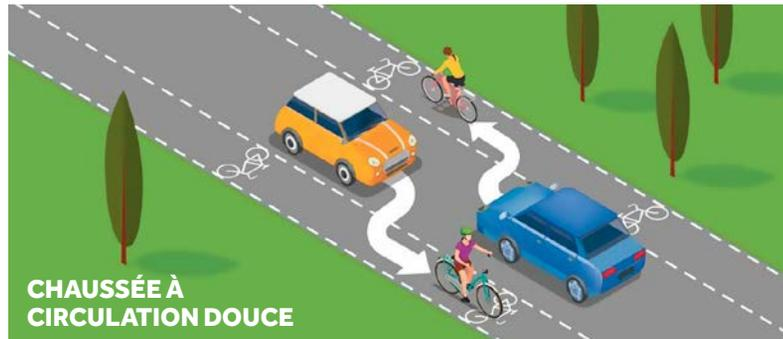
Aussi appelé chaussée à voie centrale banalisée, un chaucidou est une voie sans ligne blanche au milieu, entourée de deux couloirs. Les voitures circulent sur la voie centrale en double sens et les cyclistes sur les accotements appelés « rives ». La largeur de la voie réservée aux véhicules motorisés est insuffisante pour permettre leur croisement. Ces derniers peuvent se déporter ponctuellement sur la rive lorsqu'ils sont amenés à se croiser, mais en cédant la priorité aux cyclistes.
