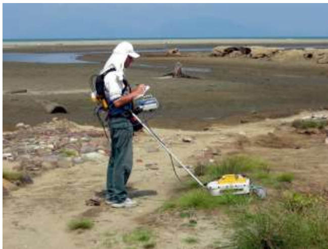
Auscultation du sol par radar par le Laboratoire de Géographie Physique situé à Meudon, 2004
